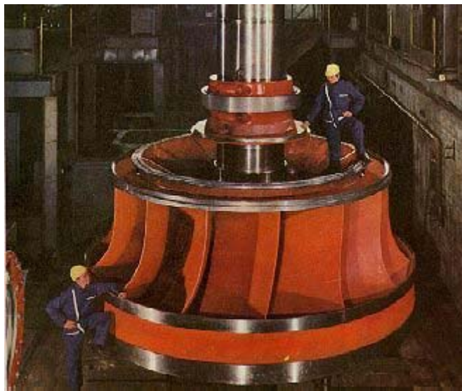
Rodete Francis para gran potencia (izquierda) y rueda Pelton de una central de EEUU (derecha).
